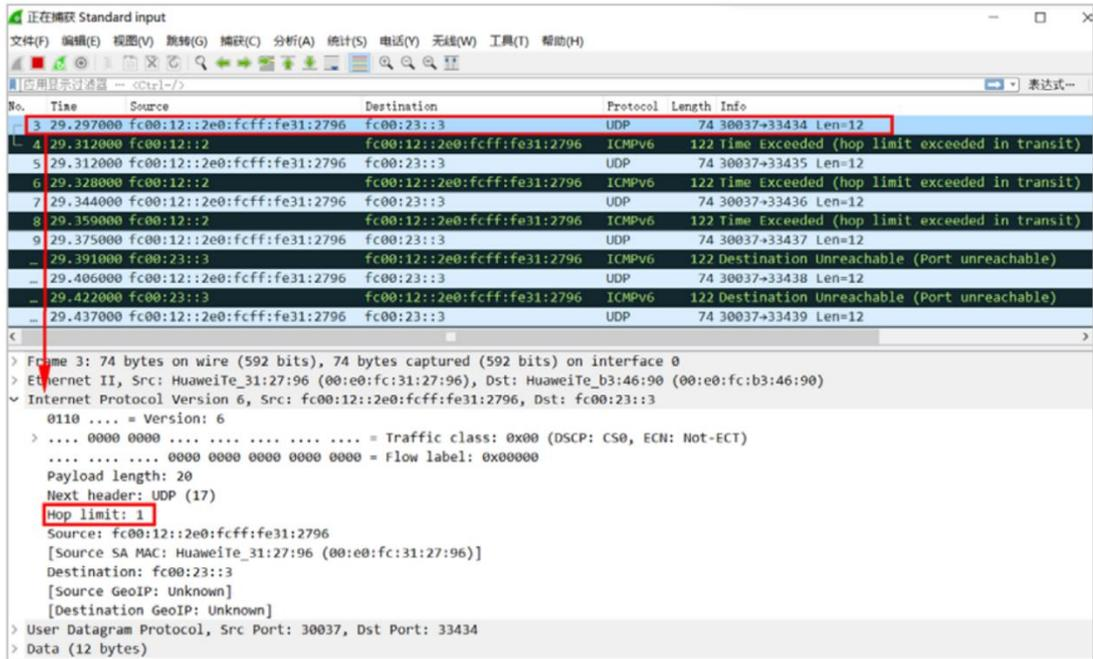
R2 收到该报文后将 Hop Limit 字段值减 1 后发现值已为 0，因此立即向 R1 发送 ICMPv6 错误消息，告知报文的生存时间截止，这个错误消息的源地址为 R2 的接口地址。R1 收到这个报错消息后，获得了第一跳设备 R2 的接口地址，然后将该地址打印在回显中。接着 R2 以 Hop Limit=2 继
