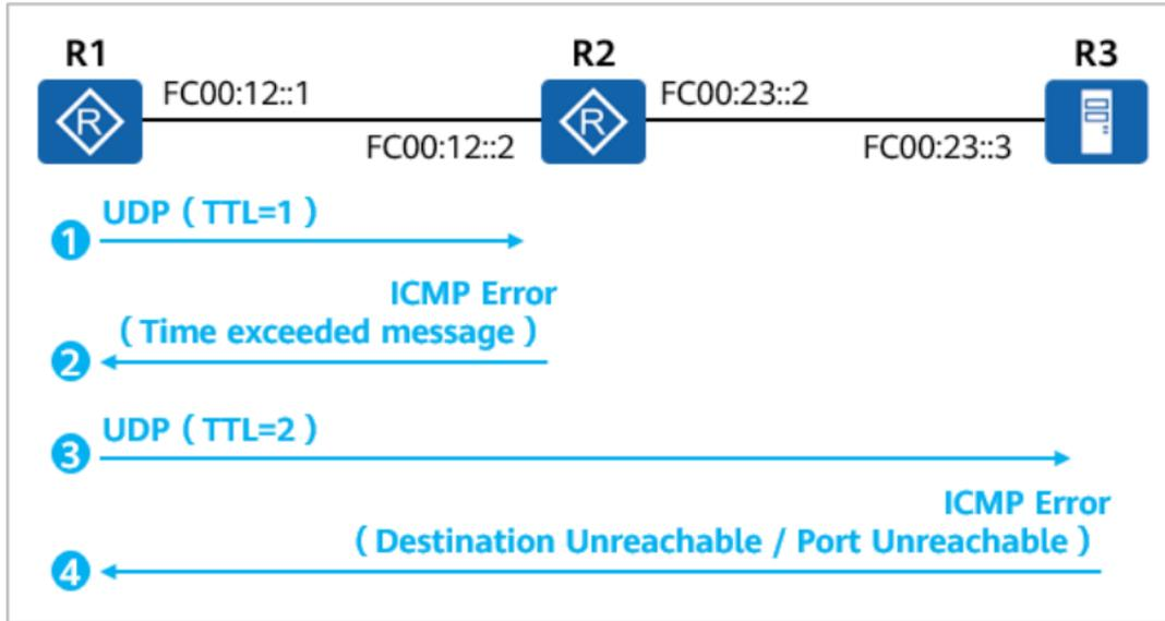
R1 首先构造第一个发往目标地址 FC00:23::3 的 UDP（UDP 目的端口为特殊的 33434，该端口不会被具体的应用所使用）报文，这个报文的内容是随机填充的，没有实际意义，但是在该报文的 IPv6 头部中，R1 将 Hop Limit 字段设置为 1，这意味着报文在发出去之后，只能传递一跳。R1 可能一次会发出多个相同的 UDP 报文。如下图所示：
