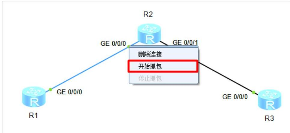
如上图所示，在 R2 的 GE0/0/0 接口上右击鼠标键，选择 GE0/0/0 接口开始进行报文抓取，该操作将调用 Wireshark 捕获 R2 的 GE0/0/0 接口上的入向与出向报文。
