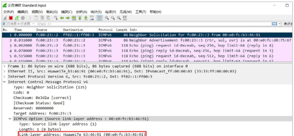
从上图可以看到，R2 (FC00:23::2) 首先发送了一个 NS 报文，该报文的 ICMPv6 载荷中带有 R2 接口的 MAC 地址信息，这个报文发往目标地址 FC00:23::3 对应的被请求节点组播地址 FF02::1:FF00:3，R3 恰恰在侦听这个地址，于是使用 NA 报文进行回应：
