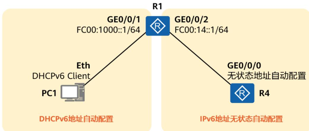
在本实验中，R1 是一台网关路由器，它通过两个物理接口分别连接物联网终端 R4（通过一台路由器模拟）及 PC1。【注】R1 及 R4 推荐使用 AR2220 及以上设备。
