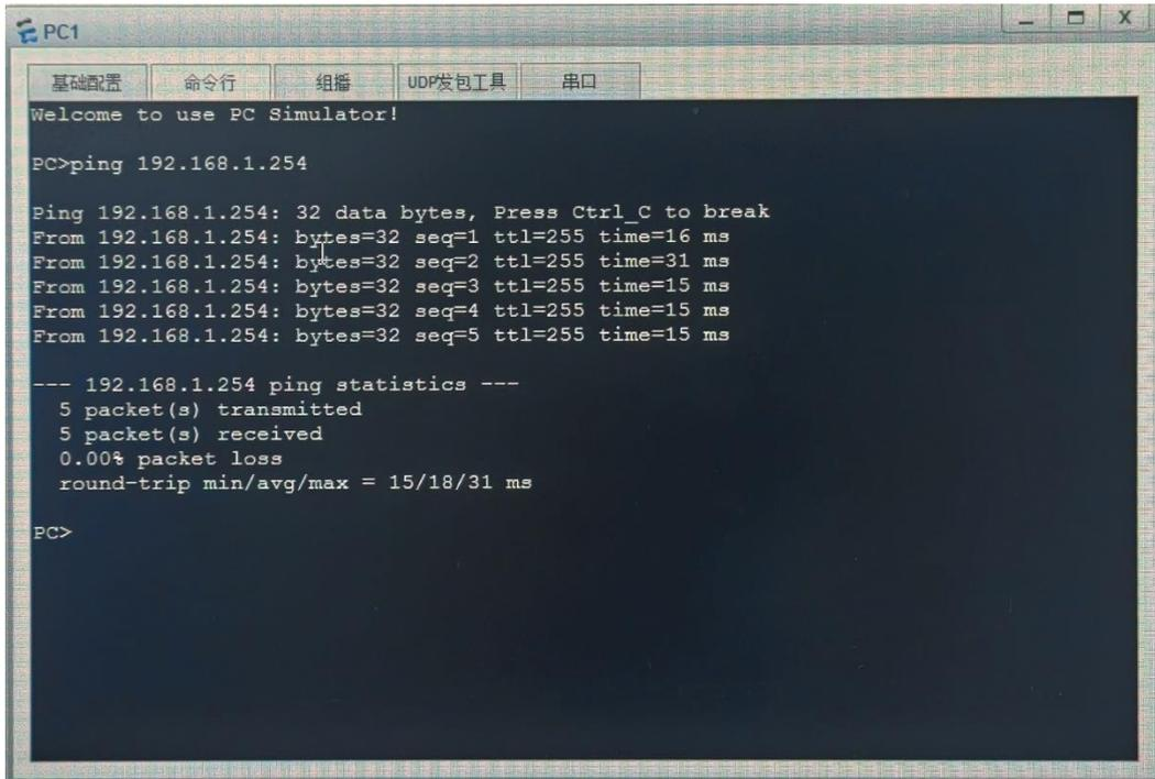
从 ping 的回显能看到，PC1 现在能够 ping 通路由器了，至此实验已经成功了。eNSP 能够保存实验拓扑及配置以便下次继续进行操作，非常方便。如果需要保存实验环境以及拓扑中各设备的配置，则在完成实验操作后，先为实验拓扑中每台设备（PC、Client 无需做这个操作）使用 save 命令保存配置（注意，务必要先在设备的 CLI 界面中使用 save 命令保存配置）：
