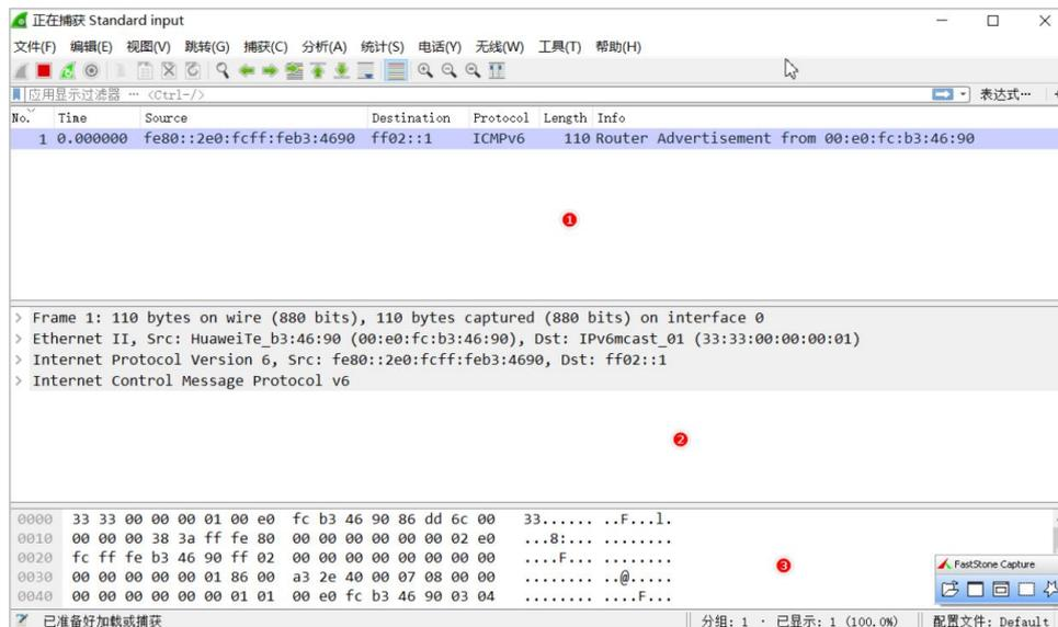
在上图所示的界面中，分栏①显示的是 Wireshark 捕获的报文列表，被选中的报文详情将出现在分栏②中，此时可在其中查看该报文的详细信息，包括二层数据帧头、三层 IPv6 头以及报文载荷，分栏③则以 16 进制形式显示报文的内容。
